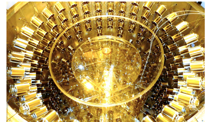
Die PMTs und Acrylbehälter im Double Chooz Detektor.
