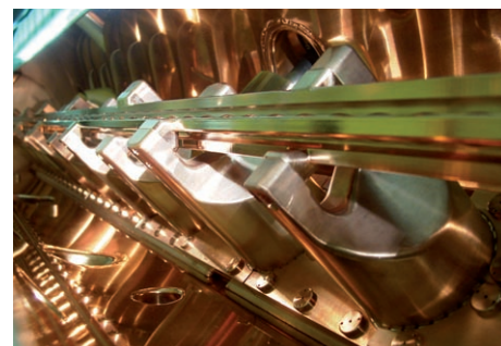
RFQ-Beschleunigerstruktur des Hochstrominjektors.
