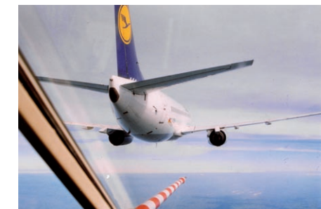
Messungen im Abgasstrahl eines Verkehrsflugzeugs (Werkstattflug); Blick aus dem Cockpit des DLR-Forschungsflugzeugs.
