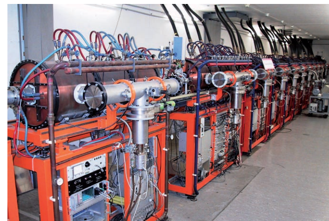
Heidelberger Nachbeschleuniger: 40 Spiralresonatoren für 108,48 MHz, 12/24 MV effektiv durchfallene Spannung (CW/Puls)
